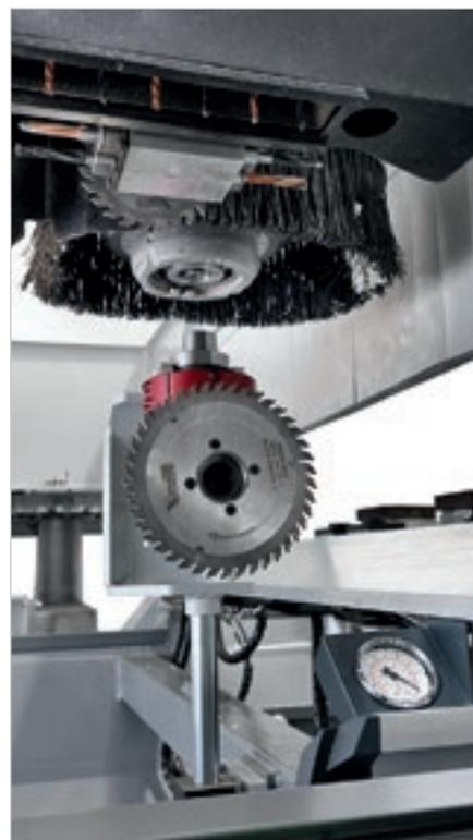
Станция **Pick Up** позволяет оснастить инструментальный магазин станка.
